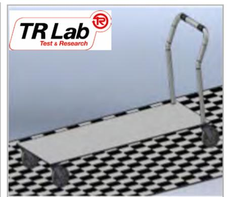
Realizzazione modello matematico di simulazione parametrizzato per misurare sforzi di movimentazione.
